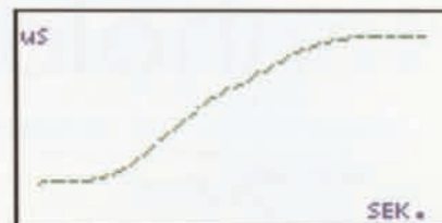
Ledningsevne i uS som funksjon av tid.
